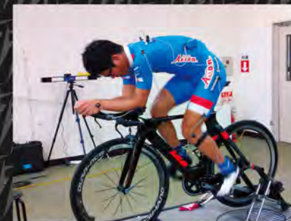
3Dモーションキャプチャー機器で動作解析
